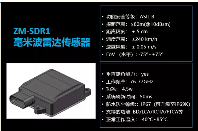
图表 29: 纵目科技4D毫米波雷达 (去掉黑点)
