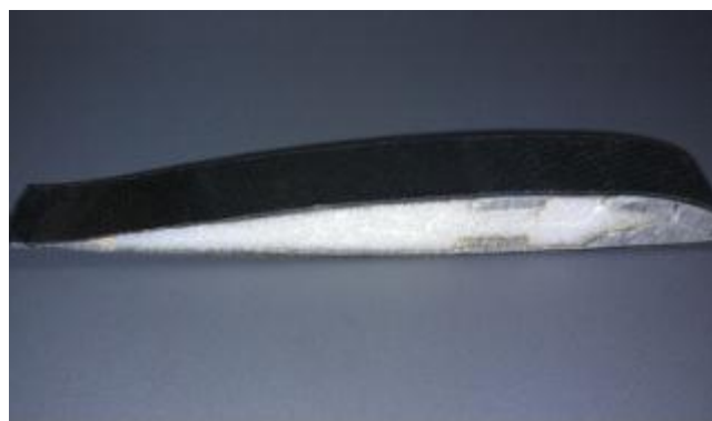
图 22: PMI 泡沫在无人机机翼中的应用
