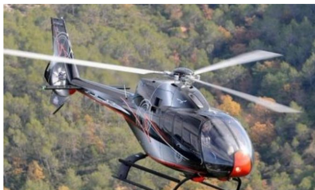
图 17：首架使用 PMI 泡沫的直升机 EC120 “蜂鸟”
