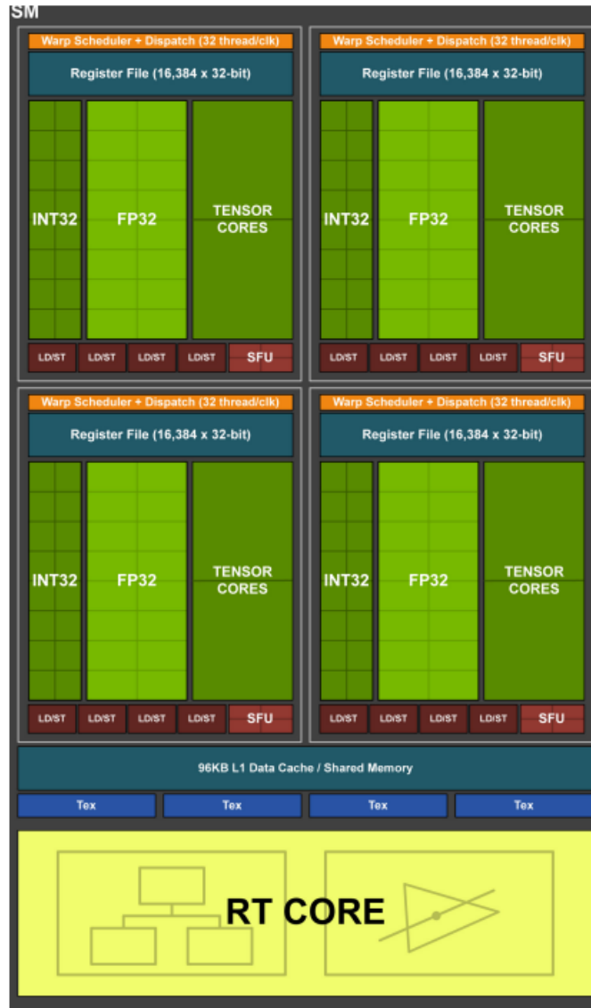
图 5: Turing 架构每个 SM 内部结构
