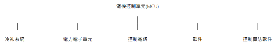
圖：電機控制單元(MCU)
