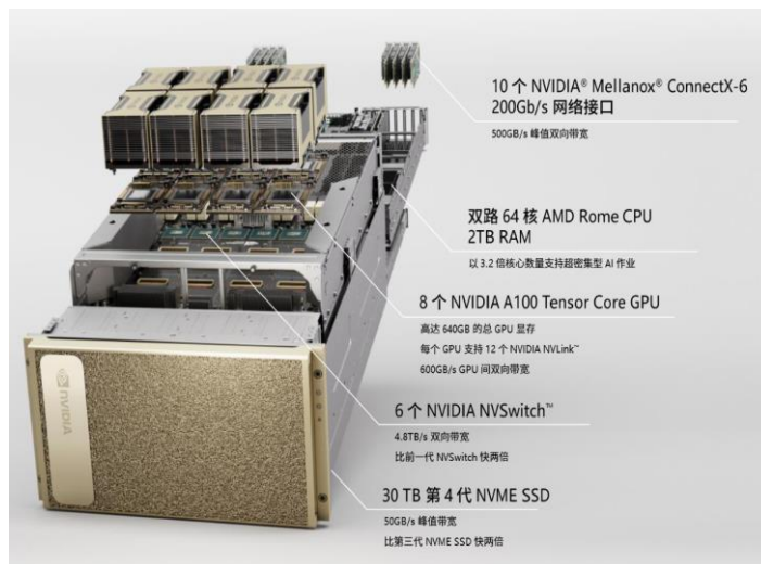
图19: Nvidia DGX A100服务器拆解图
