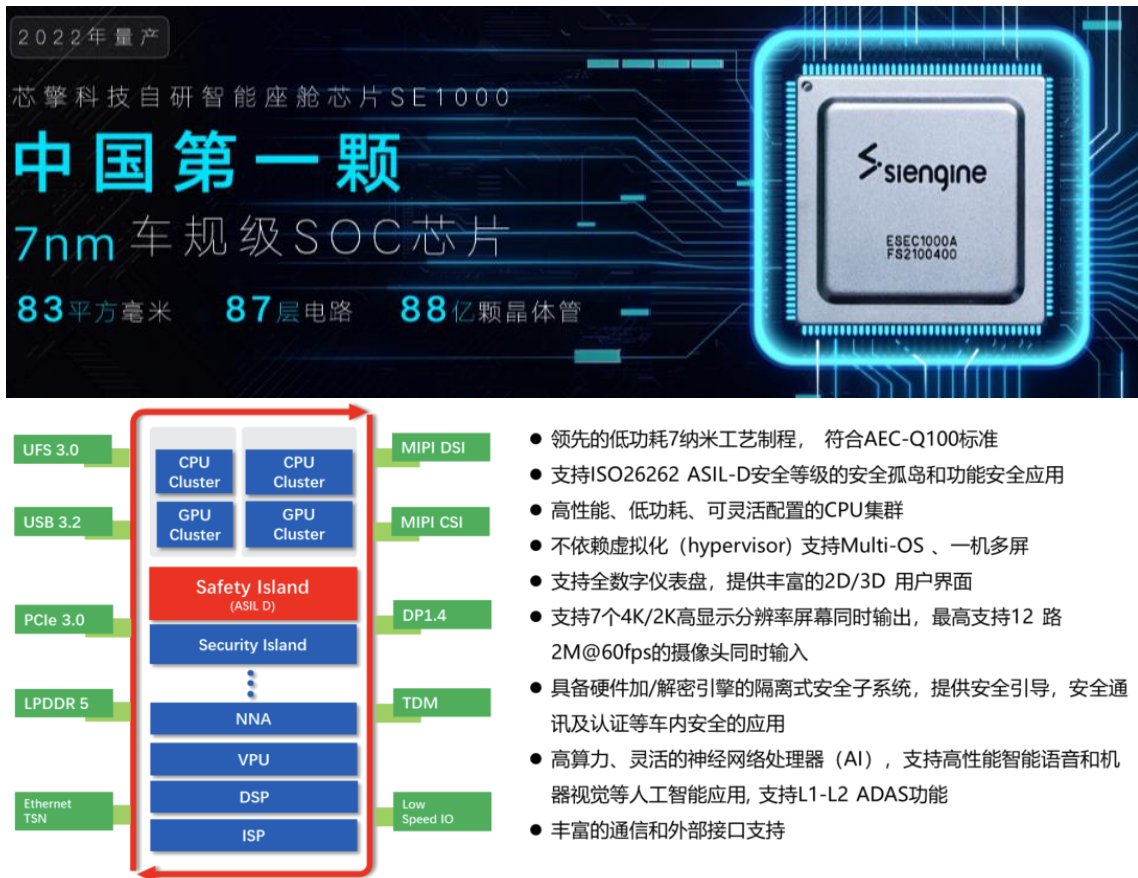
图表12 2022年吉利汽车将量产由旗下芯擎科技自研的智能座舱芯片SE1000
