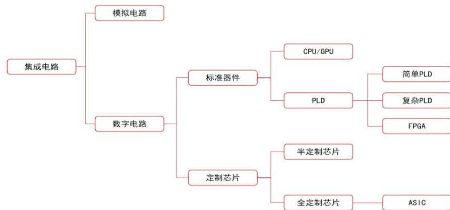
图 8：FPGA 在集成电路中的分类
