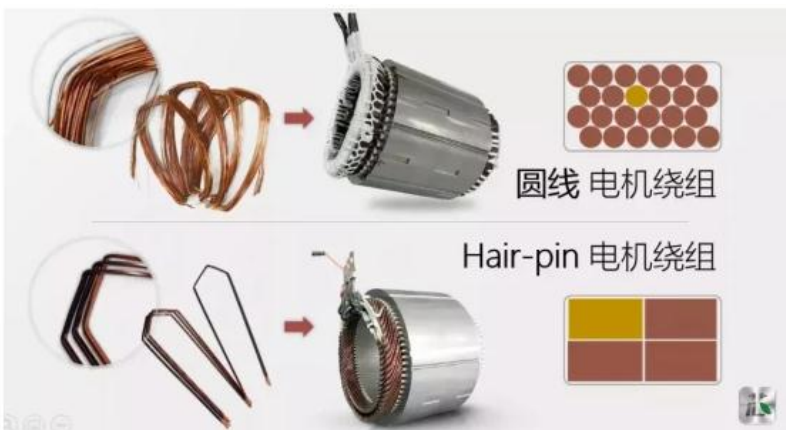
图表4：圆线电机与扁线电机对比图
