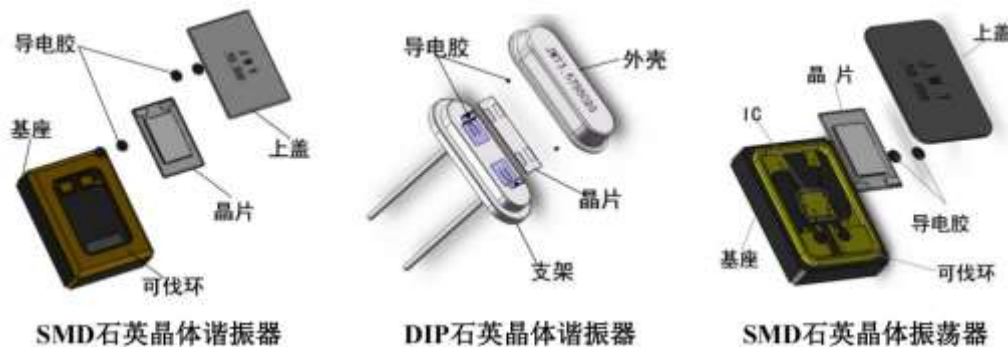
图 1：不同类型石英晶振结构
