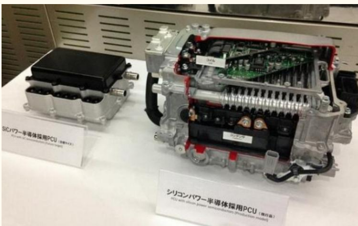
图表 19: 丰田碳化硅 PCU 与硅 PCU 体积对比
