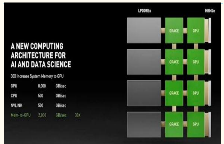
图表 33: 英伟达 Grace CPU+ GPU AI 服务器架构
