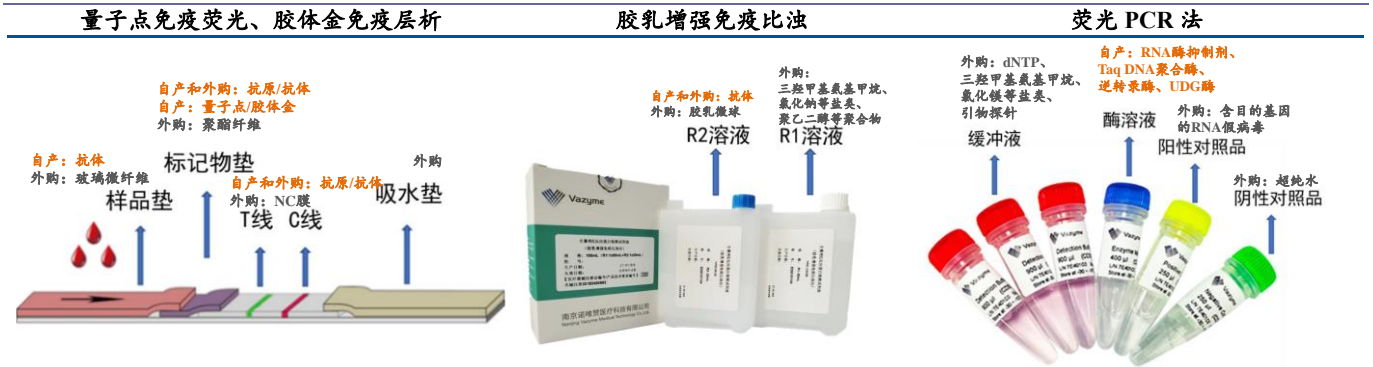
图表 85：各类 POCT 诊断试剂主要结构组成、及对应的主要原材料来源
