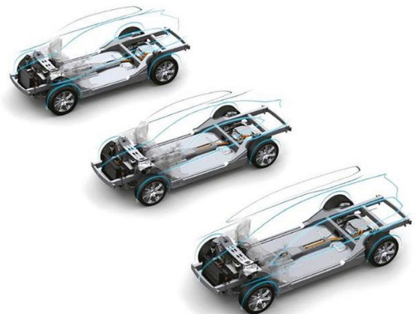
图 29：博世-本特勒合作开发电动平台的模块化应用
