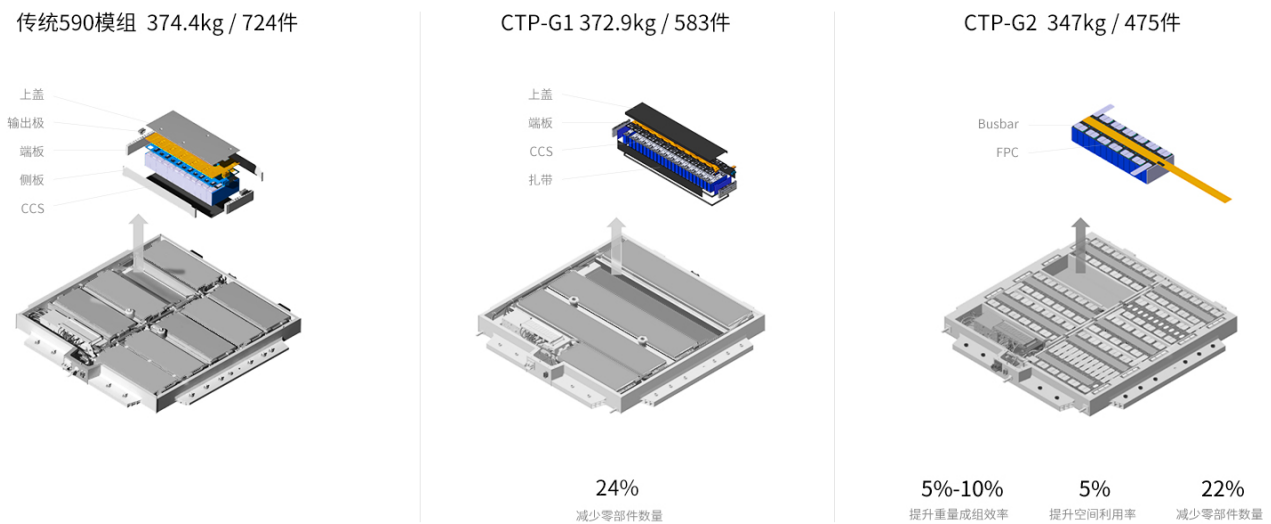
图 48：蜂巢能源 CTP 在成组效率、空间利用率、零部件数量方面的优势
