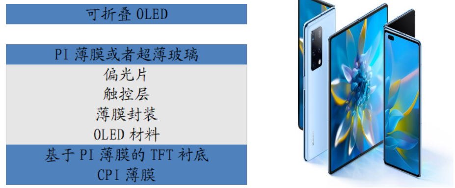
图表 52 显示用柔性屏 CPI 应用位置及示例
