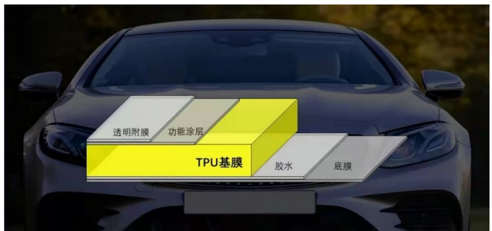
图表 48 TPU 车衣构造图
