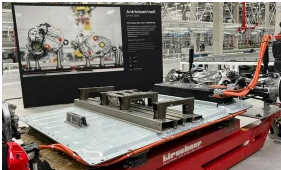
图：电池组作为车身结构一部分，前后链接大型铸件
