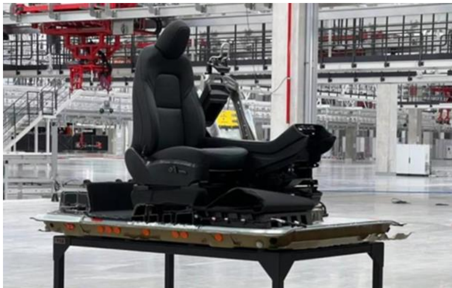
图：座椅直接安装在电池上盖上
