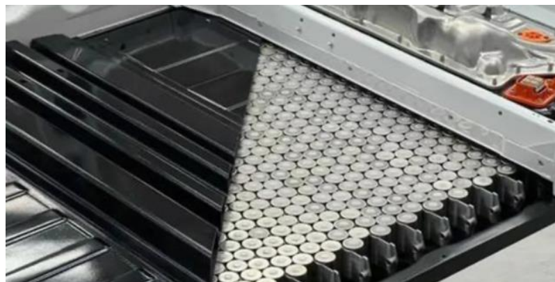
图：电芯横向排布，中间插入液冷散热片
