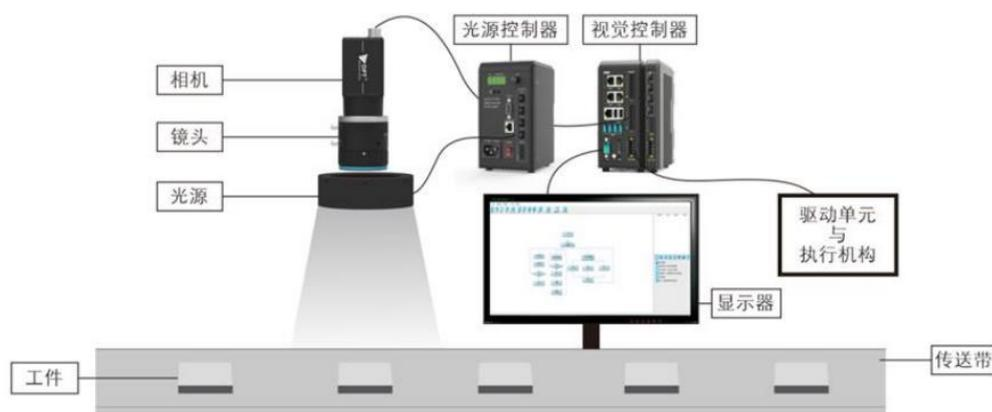
图：机器视觉示意图
