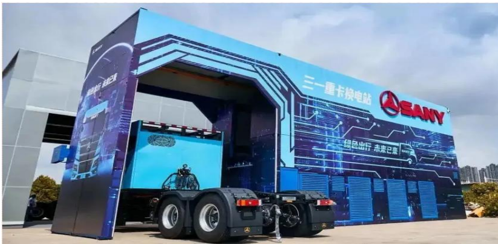
图 1：三一集团首个智能换电站，从车辆驶入、完成换电到满电驶出，整个过程不到5分钟
