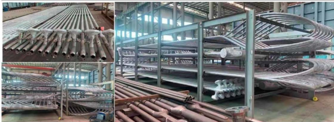
图40: 公司自主研发的高温离心铸造炉管
