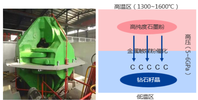
图 8：HTHP 方法示意图及所用的六面顶压机
