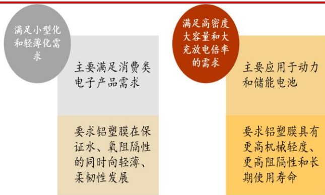
图 20 软包锂电池的两大技术方向
