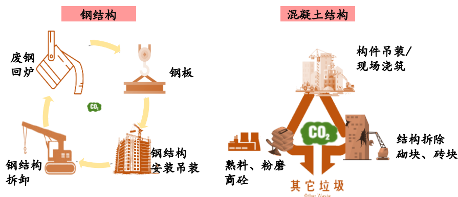
图 26：全寿命周期看，废钢参与短流程炼钢、钢结构碳排放强度低于混凝土结构
