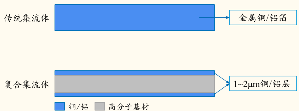
图表 25：传统集流体与复合集流体示意图
