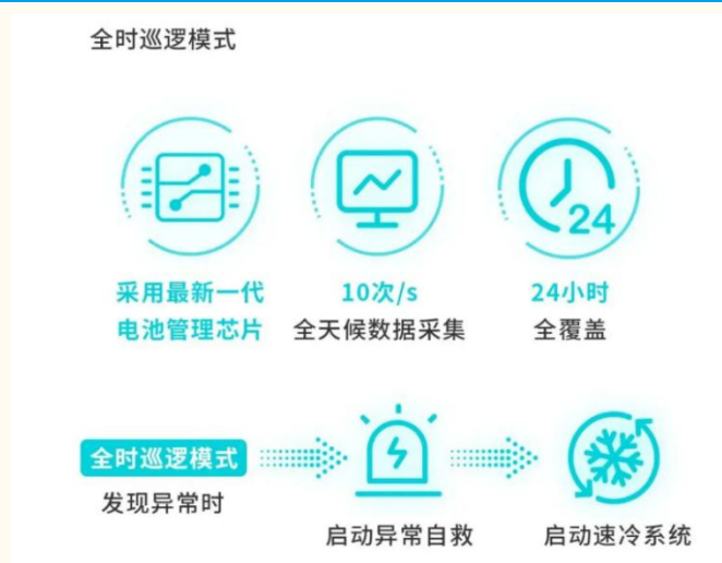
图表 40：广汽弹匣电池—第五代电池管理系统
