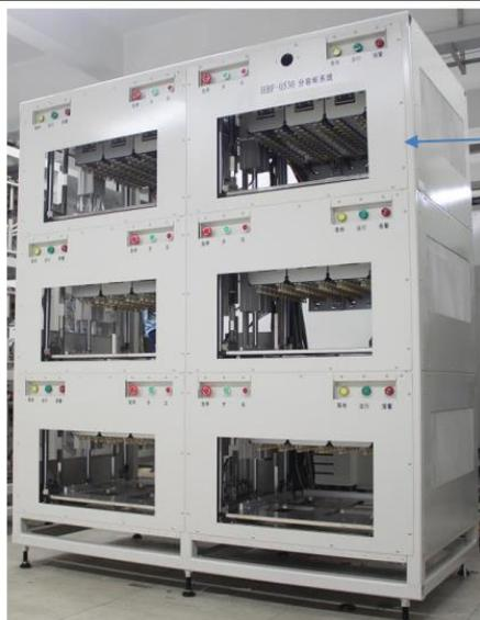
箭头所指的单元为一个 BOX，其中包含了若干个通道；6 台相同的 BOX 叠放在一起，并配上电源和外壳支架，构成了一台充放电机。
