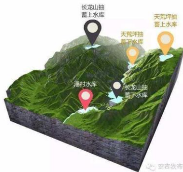
图 6：长龙山抽水蓄能电站上下水库
