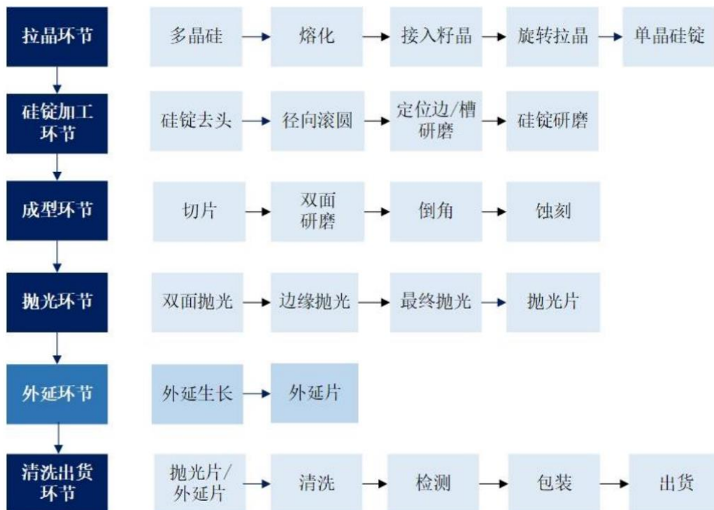
图表 132. 半导体抛光片、外延片生产工艺流程
