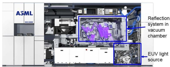
图表 100：EUV 光刻机（TWINSCAN NXE:3400B）
