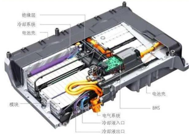
图 25: 电池壳在动力系统中的作用
