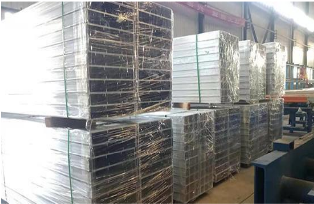
图 24: 镁合金建筑模板
