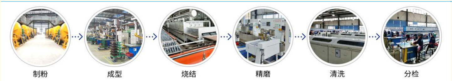
图表 18: 公司永磁铁氧体生产流程
