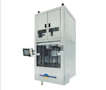
KS-M300 半自动机台可用于单片晶片涂胶、显影、喷胶、清洗、刻蚀、去胶工艺及掩膜板涂胶、显影、清洗工艺。适用于小批量生产的工艺试验和生产线。占地面积小，操作时手动上下片，工艺过程可自动完成。
