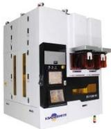
满足半导体制造中湿法刻蚀工艺，单片加工，适用于 SiO<sub>2</sub>，SiN，Polysilicon 和各种金属层的刻蚀，清洗等工艺流程。
