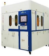
适用于半导体及 LED 芯片制造领域中的光刻胶去除、金属剥离等工艺制程。
