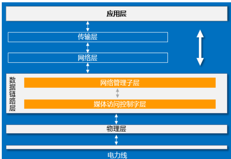
图 18：PLC-IoT 网络模型
