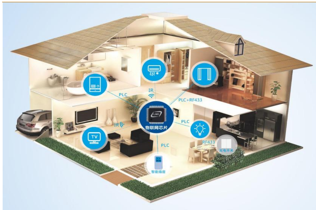
图 31：PLBus 电力线通信智能家居控制
