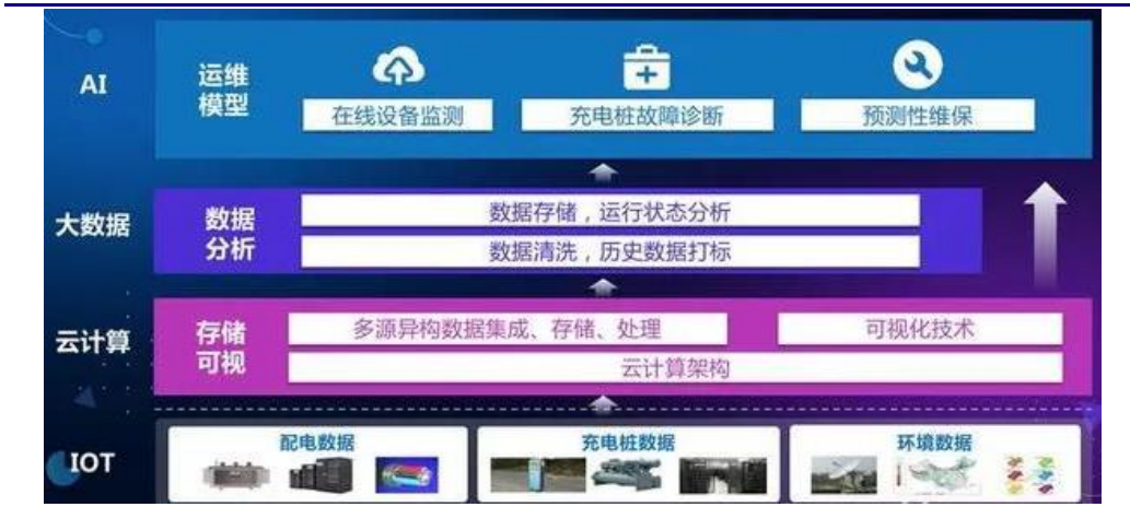
图 33: 充电桩智能管理运维系统架构
