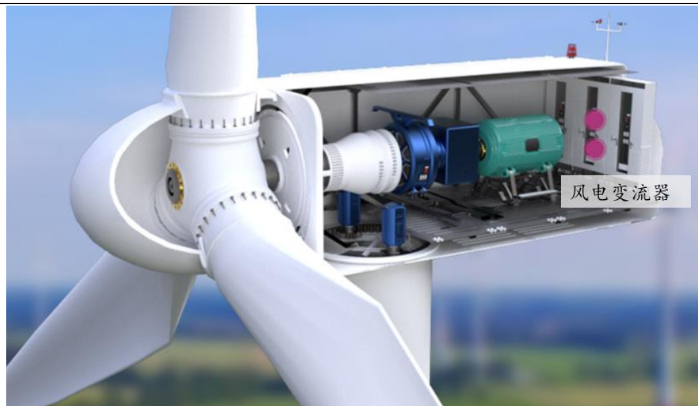
图19: 风电变流器起整流和逆变作用
