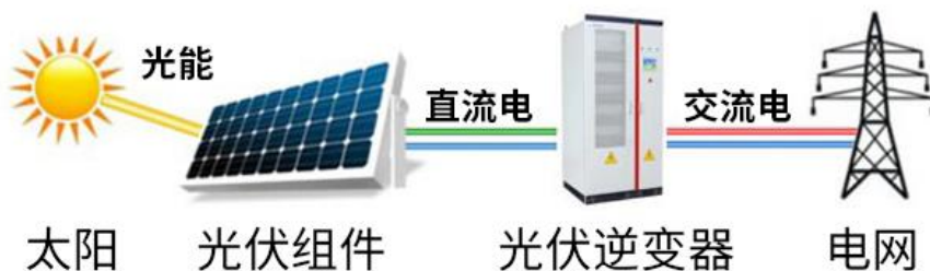
图10: 光伏逆变器将光伏组件产生的直流电逆变成交流电
