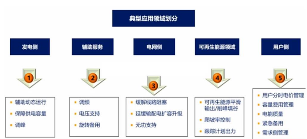
图 2：储能技术贯穿电力系统各个环节
