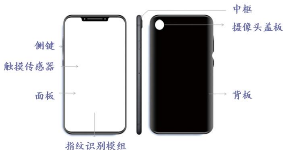
图表 4：智能手机外观结构件及模组方案的典型组件
