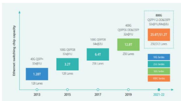
图16: 交换机算力每两年翻倍推动光模块速率需求
