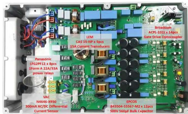
图 17：30KW 光伏逆变器拆解
