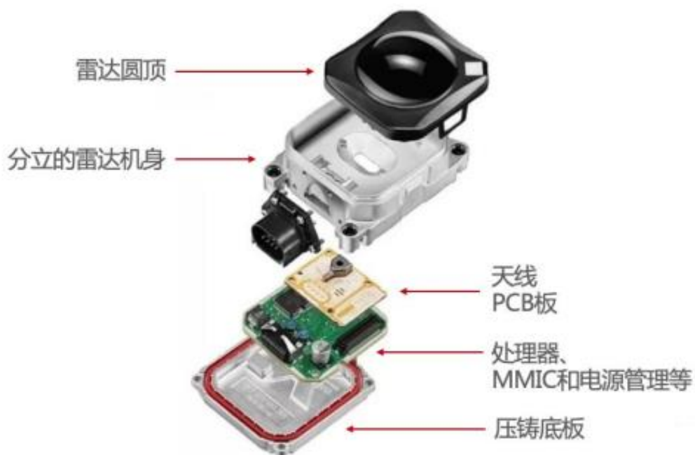
图：毫米波雷达拆解图
