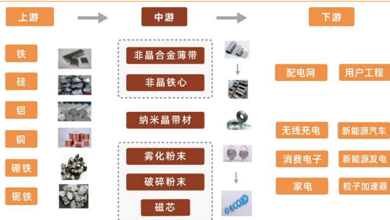
图 17：公司主营产品是非晶合金材料，产品结构丰富，下游应用广阔
