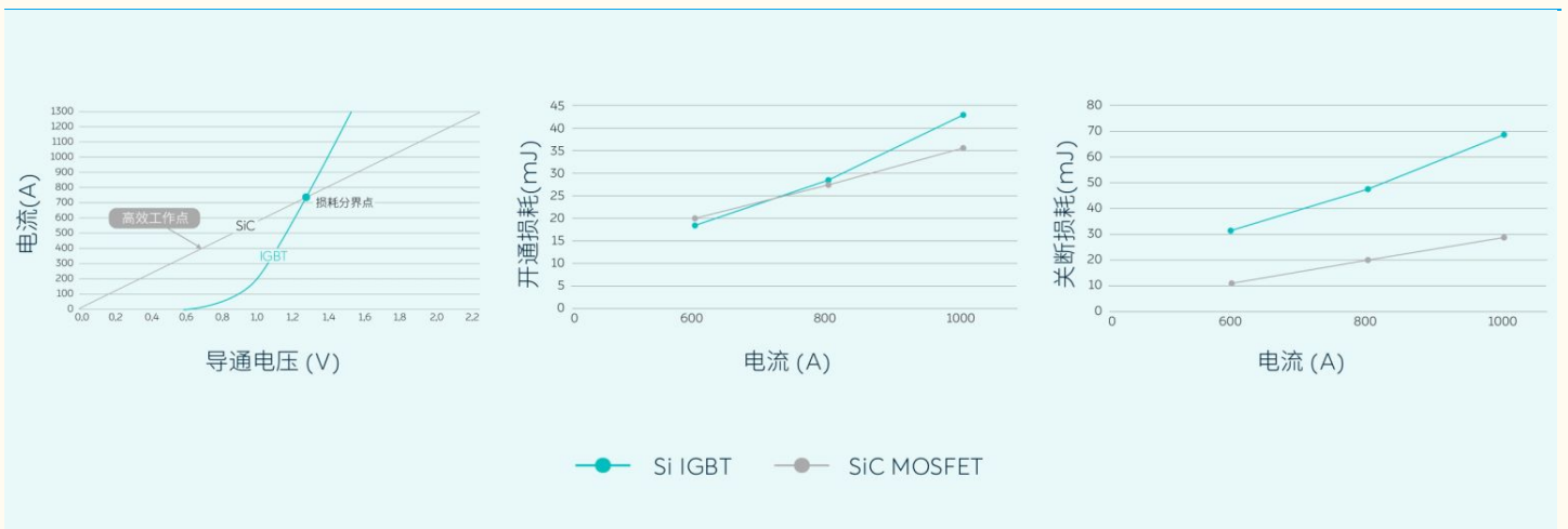
图表 18: Si 基 IGBT 与 SiC MOSFET 开通及关断损耗指标对比
