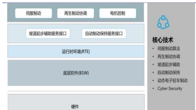
图表 25： 电子伺服制动系统框架图
