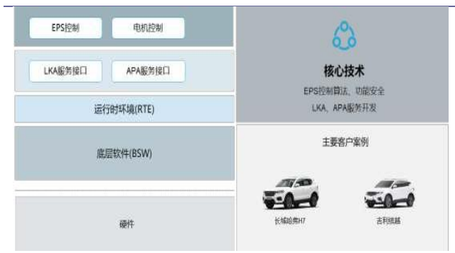
图表 24： 电子助力转向系统（EPS）软件框架及应用
