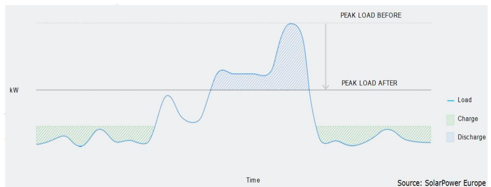
图表 114：储能可以节省电网应对尖峰负荷的投资
