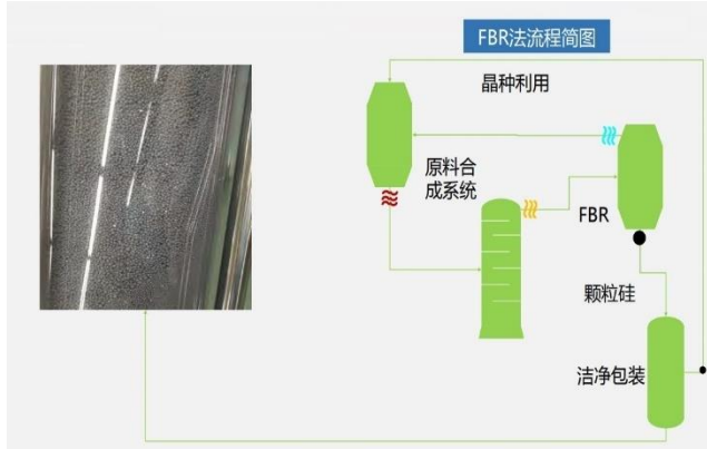
图表 59：流化床制备颗粒硅流程示意图
