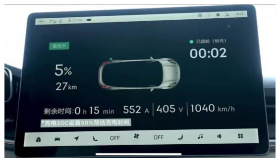
图 3：极氪 001 快充峰值电压和电流
