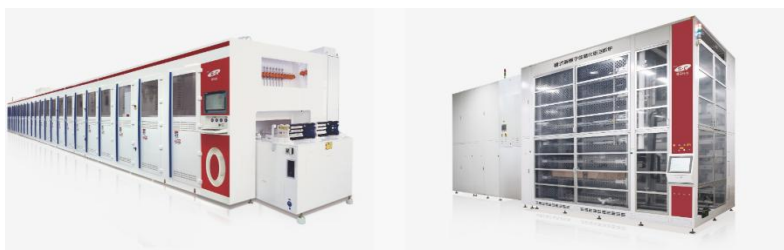
图285：HJT 清洗制绒设备、管式等离子体氧化铝淀积炉
