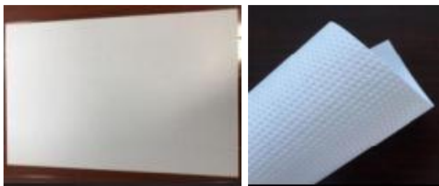
图 17：公司 PS 扩散板（左）、PE 透气膜（右）外观
