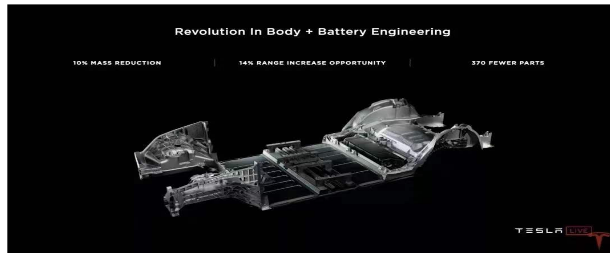
图52：特斯拉一体化压铸底盘（前车身+底盘+后座板）
