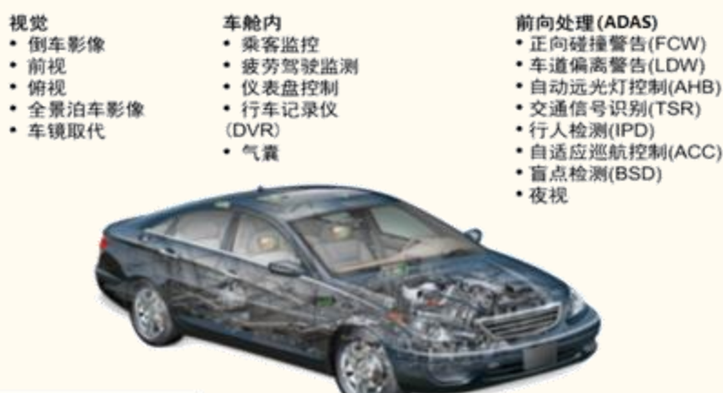
图表 17: 汽车图像传感器应用
