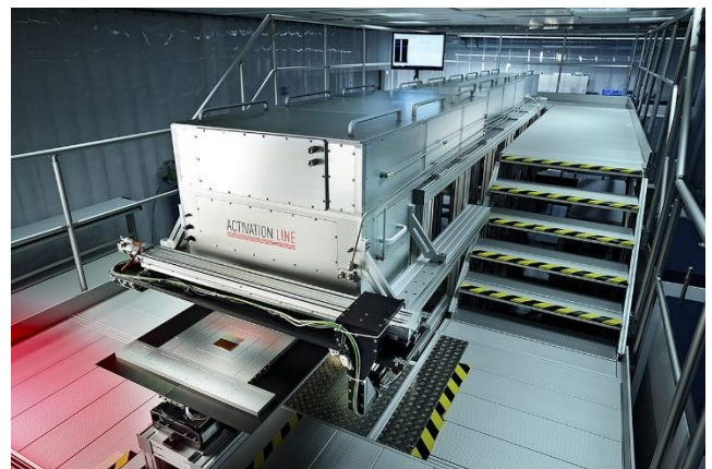
图35：UV line 激光剥离系统帮助提升激光剥离效率
