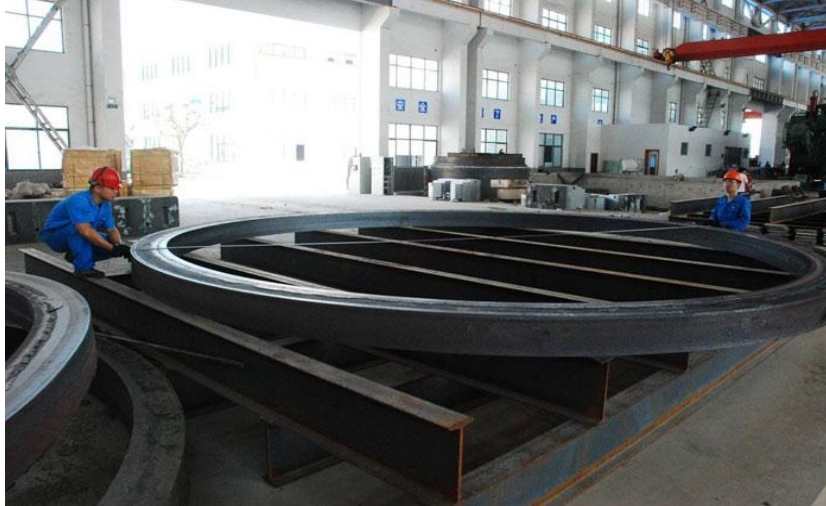
图 20：公司大型环锻件产品之一——直径 7360mm 环锻件
