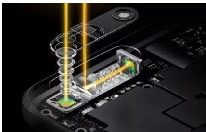
图表 42: 潜望式摄像头与传统镜头结构差别
