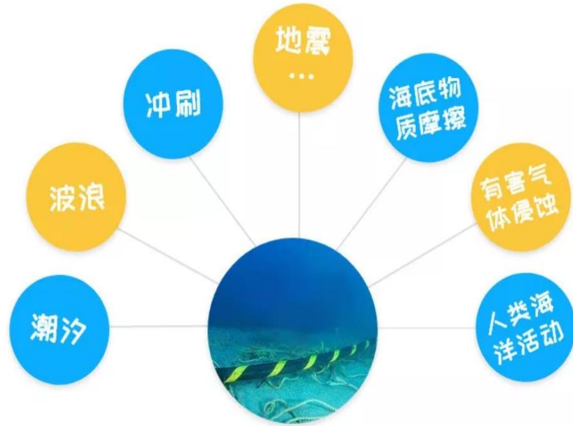
图 39：海底电缆敷设需面临多重挑战
