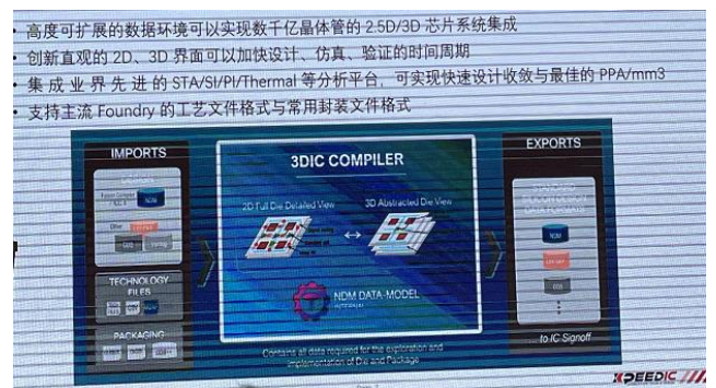
图 10：芯和半导体 2.5D/3D IC 先进封装设计分析全流程 EDA 平台
